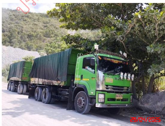
รูปที่ 7 การปิดคลุมกระบะรถบรรทุก
